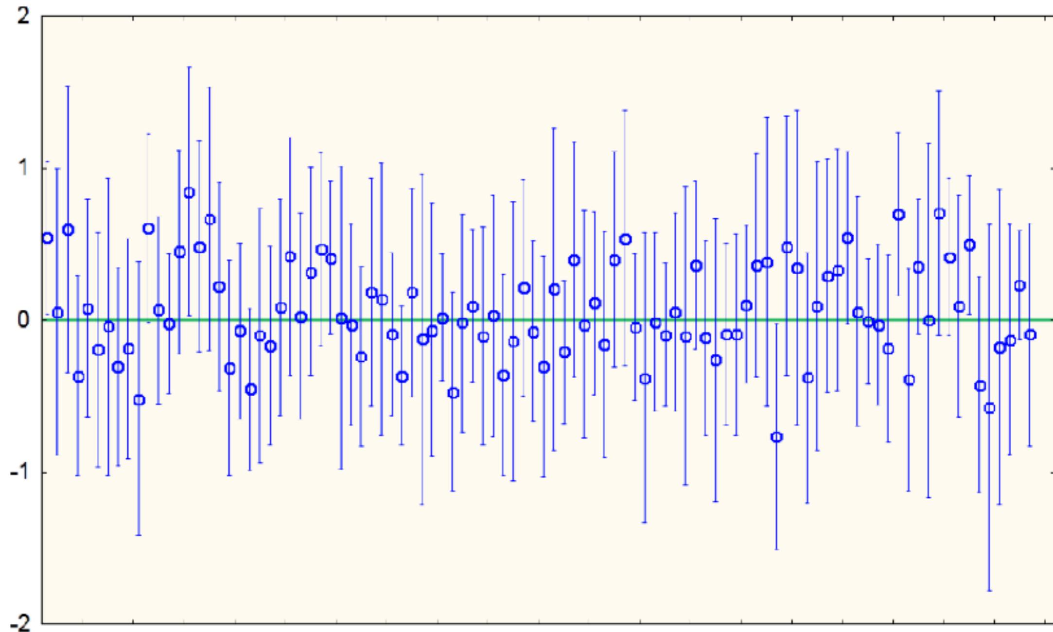
Simulační příklad:  $N=100$ ,  $\mu=0$ ,  $a=0,05$ , (5 intervalů mimo)
